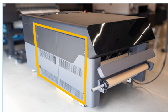
Abra la tapa de mantenimiento situada en el lado izquierdo del aparato para acceder a los filtros.
