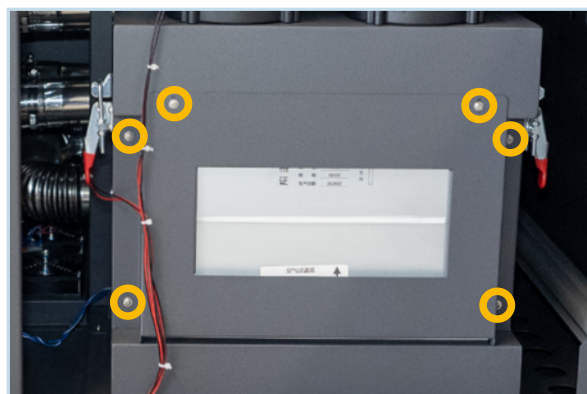
Retire la cubierta metálica aflojando los 6 tornillos.
